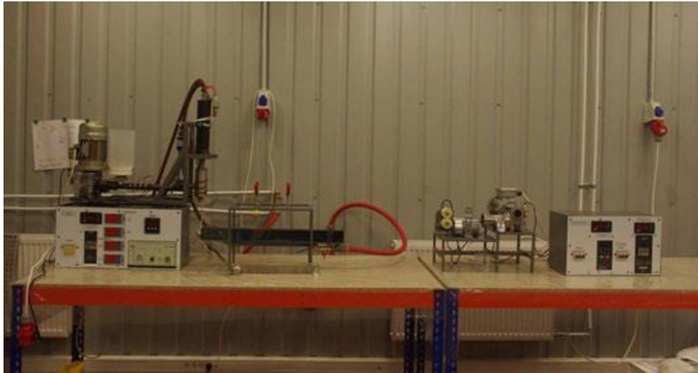
Рисунок 2.2 – Лабораторный экструдер с ультразвуковой обработкой расплава
