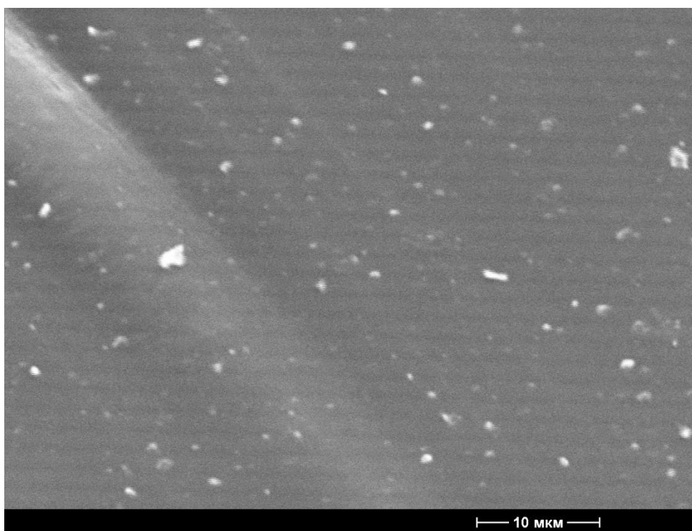
Рисунок 3.14 – Микрофотография структуры поверхности пленки на основе ПЭ и бетулина в количестве 5 об. %, полученной при воздействии УЗ
