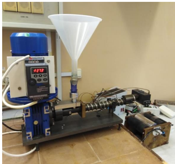
Рисунок 2.3 – Лабораторная экструзионная установка для получения плоских пленок
